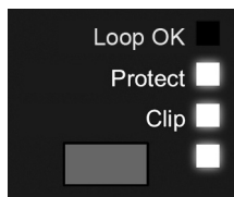
Boucle défectueuse, entrée trop haute et/ou amplificateur surchargé
